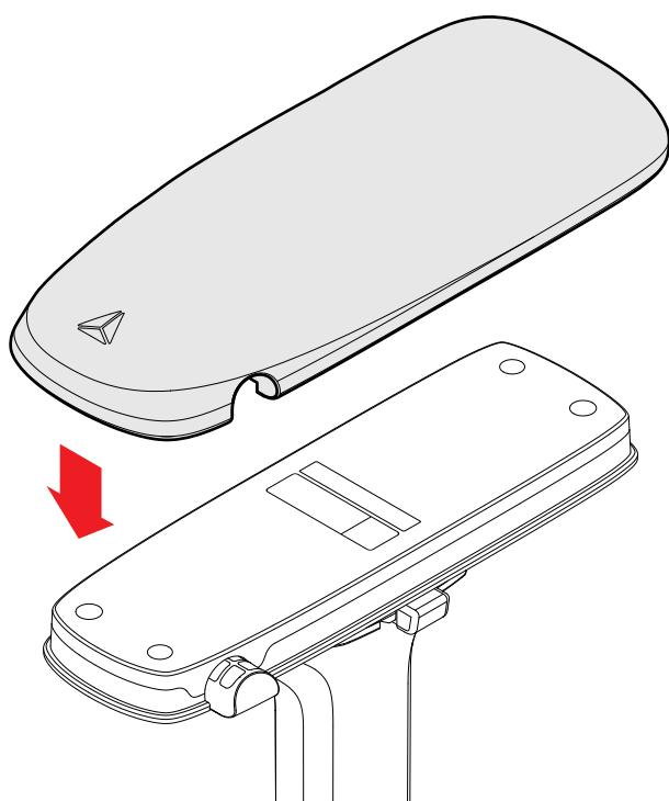
**16** Placera den magnetiska nackkudden på ryggstödet som på bilden för att fästa den magnetiskt. Din Secretlab-stol är nu färdigmonterad!
