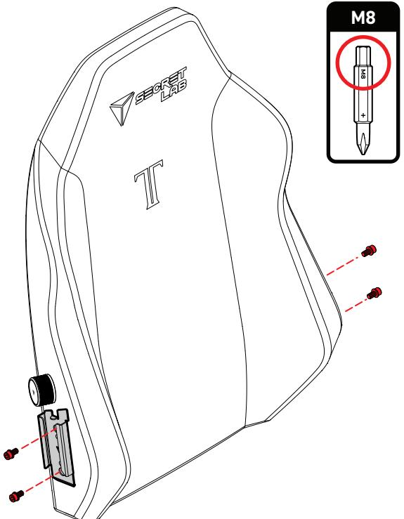
**05** Die rechte Rückenlehnenhalterung bis zum Anschlag nach unten auf die rechte Lehnenhalterung schieben. Die M8-Schrauben (aus Schritt 4) einsetzen und bis zur Hälfte einschrauben.
