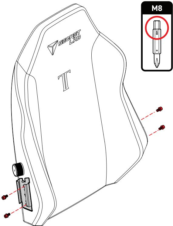
**05** Glissez la fixation droite du dossier dans le support d'inclinaison droit jusqu'à l'arrêt. Insérez les vis M8 (de l'étape 4) et vissez-les à moitié.
