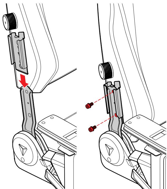
**06** Spingere in alto il supporto sinistro reclinabile per allinearla con i fori sulla sinistra dello schienale. Inserire le viti M8, poi stringerle completamente tutte e 4 su entrambi i lati dello schienale, usando la chiave esagonale lunga.
