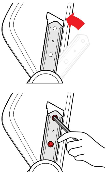
**07** Installare le coperture magnetiche laterali allineandole sopra i supporti reclinabili dello schienale, su entrambi i lati. Si posizioneranno magneticamente.
