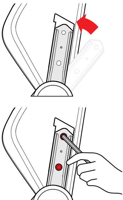
**07** Installez les pans latéraux magnétiques en les alignant de chaque côté par-dessus les supports de fixation du dossier. Ils se clipseront magnétiquement à leur place.
