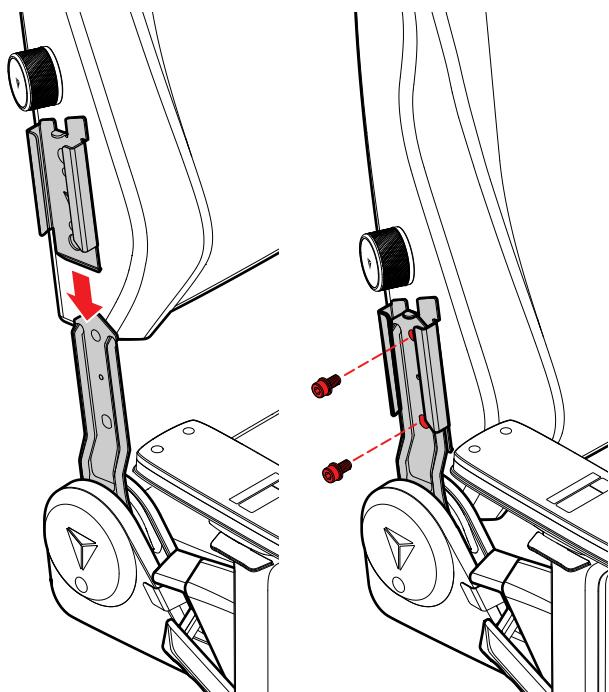
**06** Empuja el soporte reclinable izquierdo hacia arriba para alinearlo con los agujeros para tornillos de la izquierda del respaldo. Inserta los tornillos M8 y aprieta a fondo los 4 tornillos de ambos lados con la llave allen larga.
