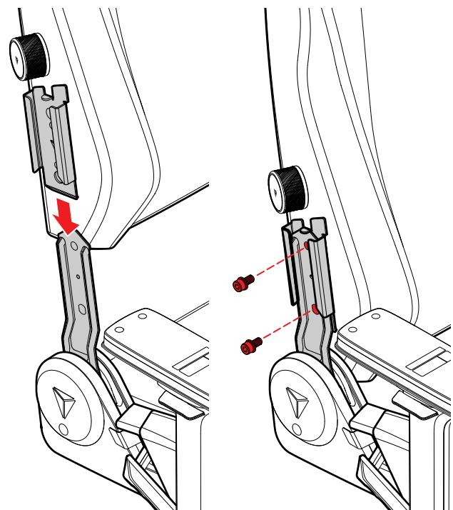
**06** Poussez le support d'inclinaison gauche pour l'aligner avec les trous de vis à gauche du dossier. Insérez les vis M8 et vissez complètement les 4 vis sur les deux côtés à l'aide de la clé allen.
