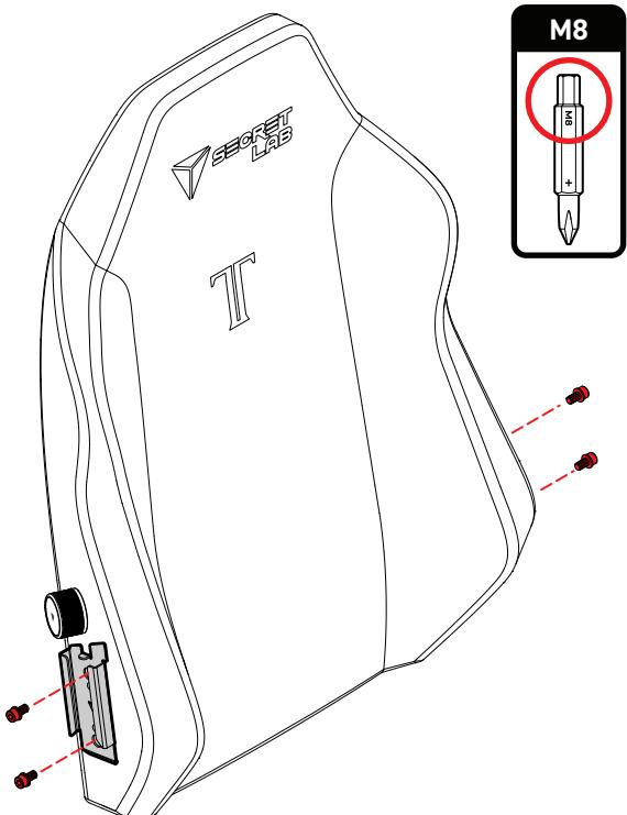
**05** Przesuń gniazdo oparcia po prawej stronie w dół na prawy wspornik podparcia, do momentu zatrzymania. Włóż śruby M8 (z kroku 4) i dokręć je do połowy.
