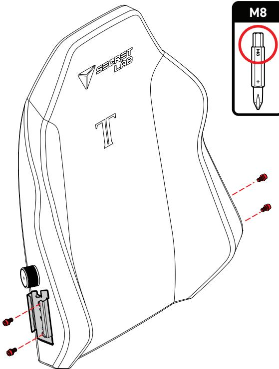
**05** Masukan braket sandaran yang ada dibagian kanan bawah ke braket sandaran kanan. Masukkan sekrup M8 (dari langkah 4) dan kencangkan. Jangan kencangkan sepenuhnya .
