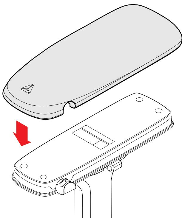
**16** マグネット式ヘッドピローを図のように背もたれの上に置くと、マグネットがチェアに固定されます。
