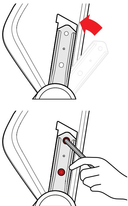
**07** Monter de magnetiske sidedæksler så de flugter med ryglænsbeslagene på begge sider. De klikkes magnetisk på plads.
