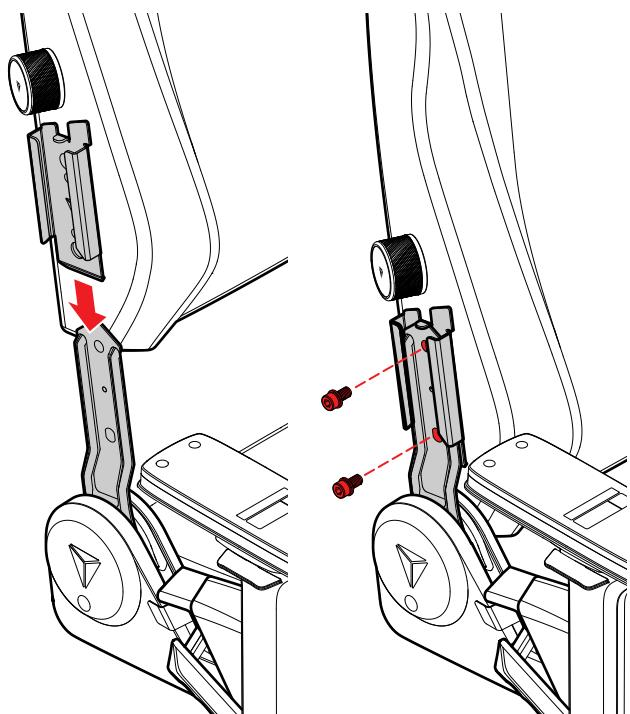
**06** Przesuń lewy wspornik oparcia do góry, aby wyrównać go z otworami na śruby po lewej stronie podparcia. Włóż śruby M8 i całkowicie dokręć wszystkie 4 śruby po obu stronach za pomocą długiego klucza imbusowego.
