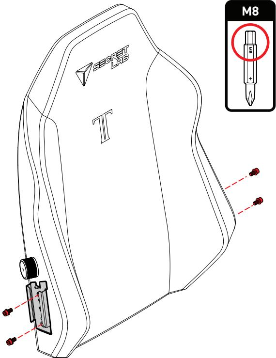
**05** Skub ryglænets højre beslag fast på det højre vippebeslag, indtil det ikke kan mere. Indsæt M8 skruerne (fra trin 4) og drej dem halvt i.
