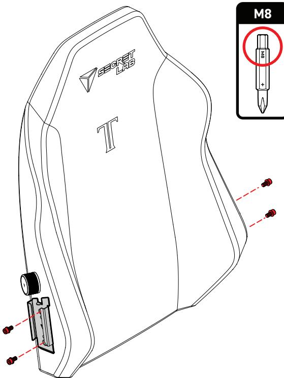
**05** Skjut ner ryggstödsfästet till höger på det högra lutningsfästet tills det tar stopp. Sätt i M8-skruvarna (från steg 4) och skruva in dem halvvägs.
