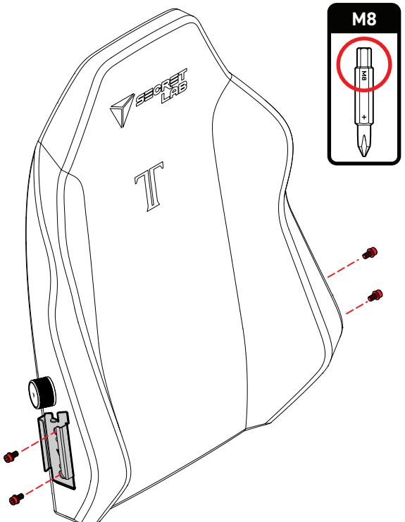
**05** Desliza hacia abajo el soporte del respaldo de la derecha hacia abajo sobre el soporte reclinable derecho hasta que se pare. Inserta los tornillos M8 (del paso 4) y enróscalos hasta la mitad.
