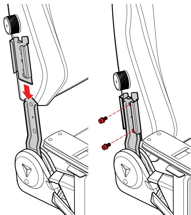
**06** Skjut upp det vänstra lutningsfästet så att det ligger i linje mot skruvhålen på vänster sida av ryggstödet. Sätt i M8-skruvorna och dra åt alla 4 skruvar ordentligt på båda sidor med den långa insexyckeln.
