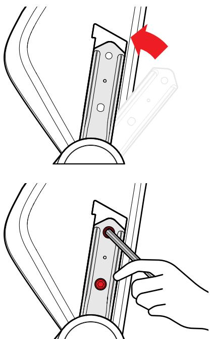
**07** Instala las tapas laterales magnéticas alineándolas encima de los soportes del respaldo en ambos lados. Encajarán magnéticamente en su sitio.
