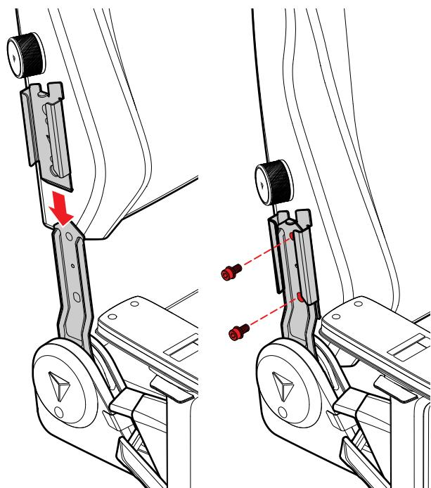
**06** Die linke Lehnenhalterung nach oben schieben, bis sie mit den Schraubenlöchern auf der linken Seite der Rückenlehne übereinstimmt. Die M8-Schrauben einsetzen und alle 4 Schrauben auf beiden Seiten mit dem langen Inbusschlüssel fest anziehen.
