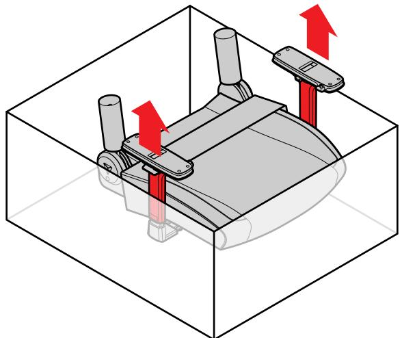
03 **اقلب قاعدة العجلات إلى الوضع العادي، وأدخل الكباس الهيدروليكي. أزلك جلبة الكباس على الكباس.**
